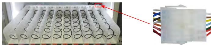
2. Desaparafuse a mola no lado direito da coluna a ser unida, desmonte o parafuso defletor do meio da coluna para ser fundido (o defletor de plástico pode ser empurrado diretamente para dentro e removido) e remova o defletor. A coluna ficará mesclada.
